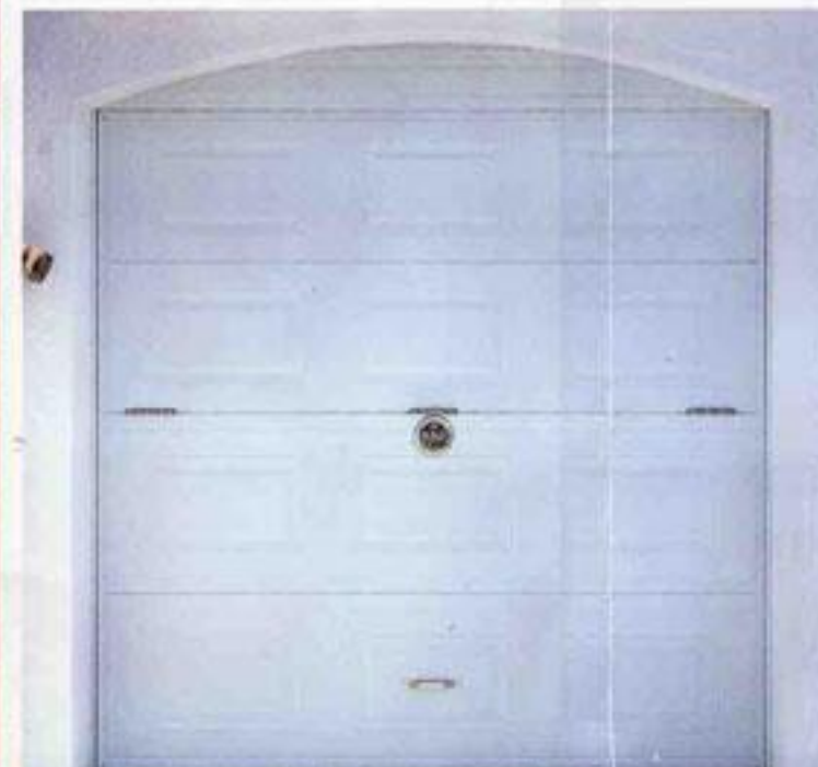
Porta basculant automàtica de dues fulles. Estructura galvanitzada folrada de doble xapa lacada blanca amb poliuretà expandit a l'interior, tipus sandwich. L'acabat és a quarterons, amb punt d'arc i amb tarja fixe a la part superior.
